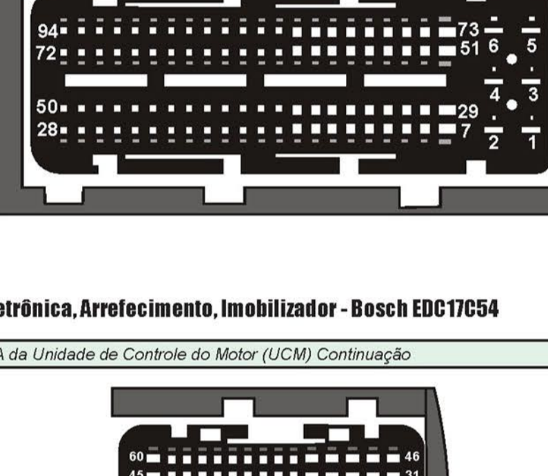
Pin-ou do conector K da Unidade de Controle do Motor (UCM) Continuação
